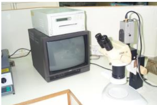
圖：連監視器與彩色印表機之光學放大鏡量測系統
